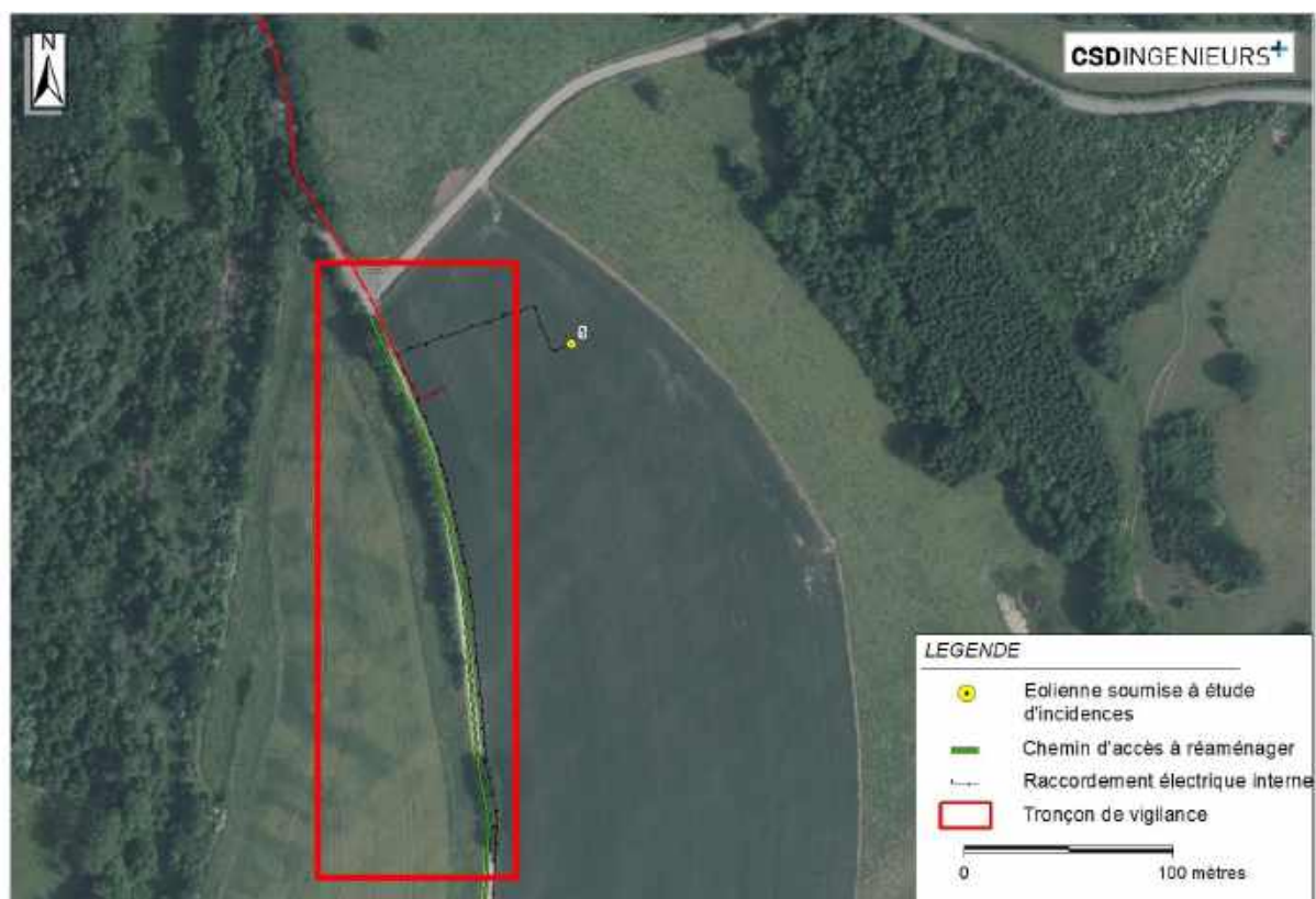
Figure 97 : Localisation du tronçon pour lequel une vigilance doit être accordée en phase de chantier afin de maintenir les éléments arborés à proximité de l'éolienne n°5
