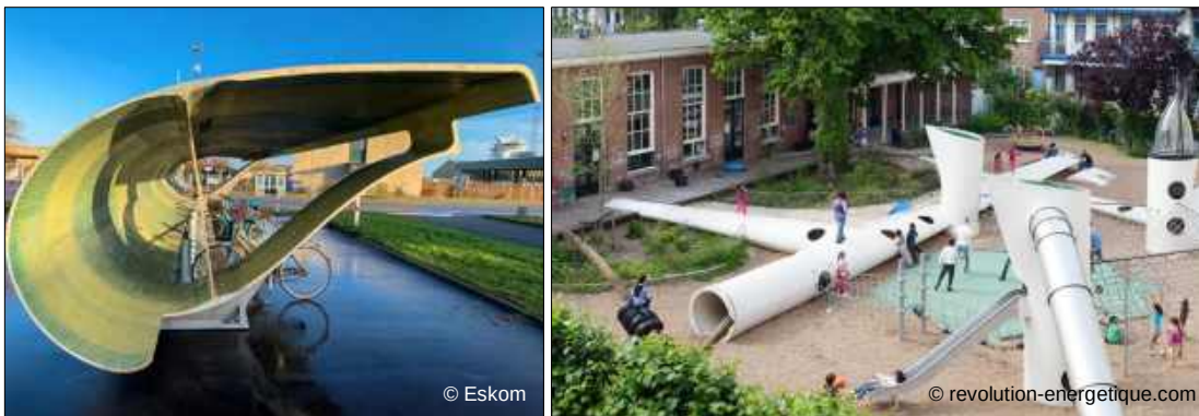
Figure 24 : À gauche : section de pale d'éolienne transformée en garage à vélo (Danemark) ; à droite : sections de mâts et de pales transformées en éléments de plaines de jeux (Pays-Bas).
