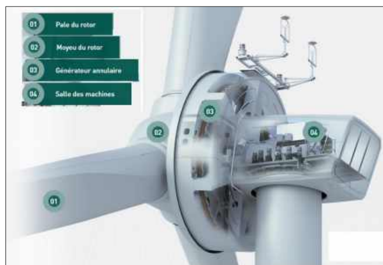
Figure 5 : Composantes d'une éolienne à génératrice synchrone (source : Enercon, 2019).
